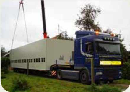
Transport eines großen Luftwäschers
